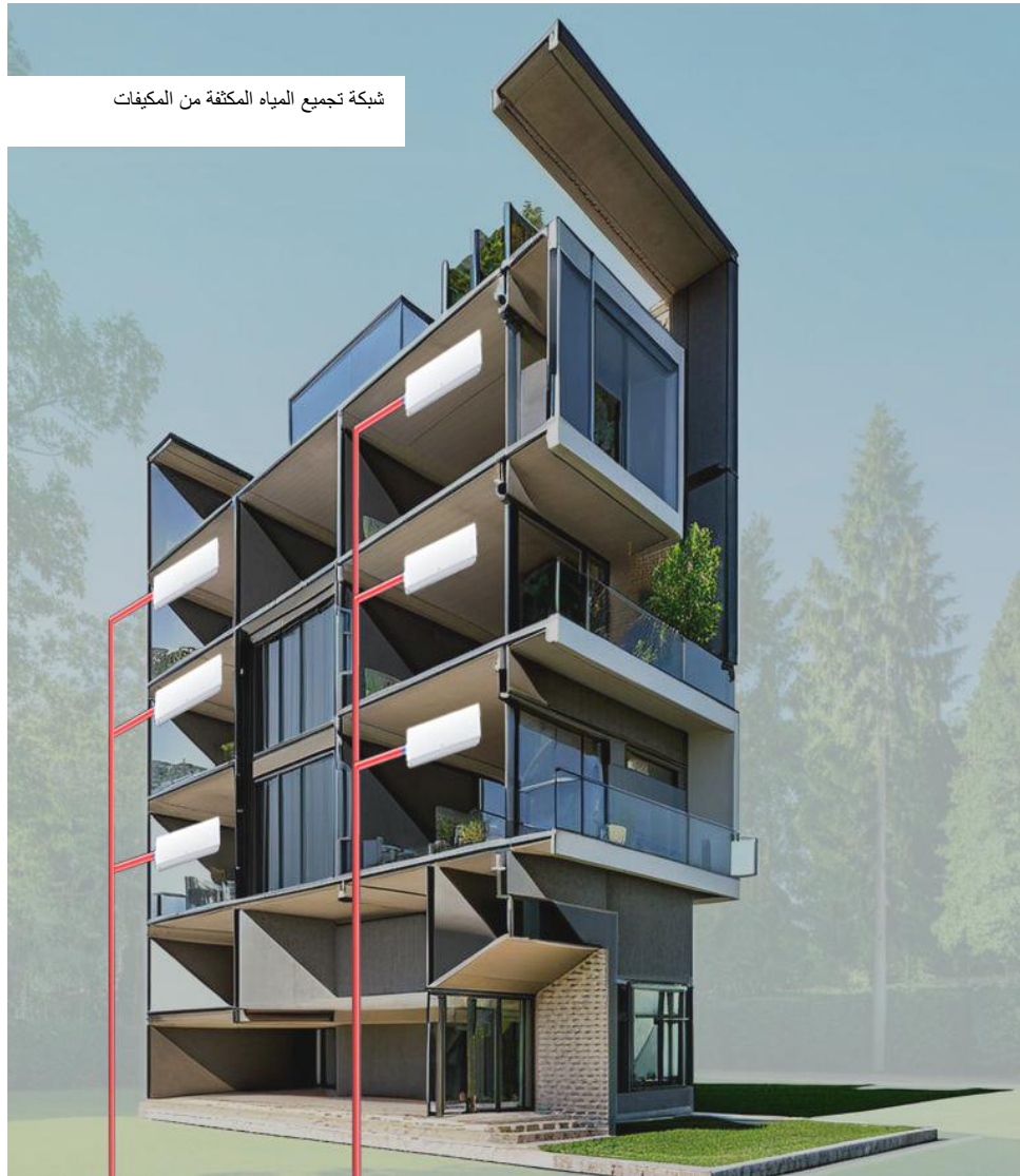
شكل 4: رسم توضيحي لنظام تجميع المياه المكثفة من أجهزة التكييف
